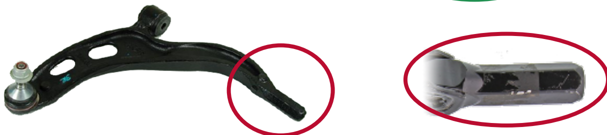
Figure 1. Bras de suspension Mevotech Supreme CMS401119 avec bague de conformité prémontée (en haut) comparativement au bras de suspension d'origine nu (en bas)
