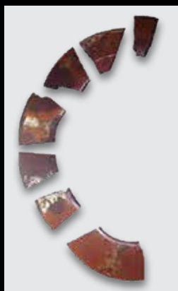
Ressort disque défaillant
