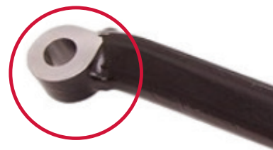
Figure 1: Bras de suspension à « col aminci » - avant 2006
