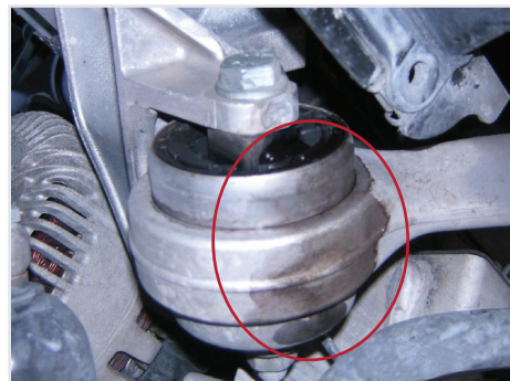
Figura 1: Fuga de fluido hidráulico del buje. Un indicador de falla del buje.
