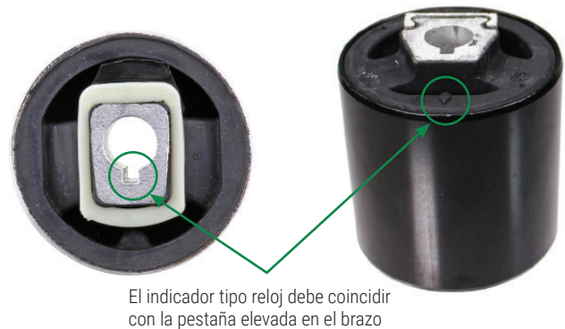
Figura 2: Ejemplos de indicadores tipo reloj
