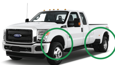
Figura 1: eje de banda de rodamiento ancha con molduras de salpicadera grandes y ruedas traseras dobles
