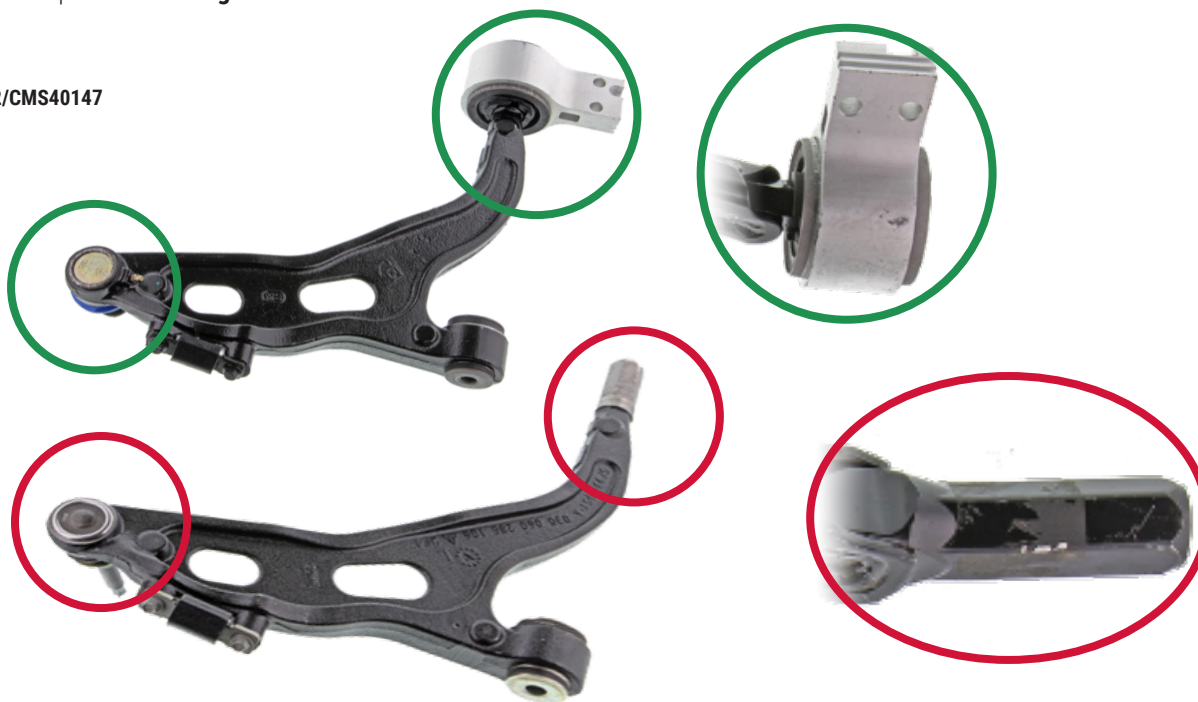
Figure 1. Bras de suspension Mevotech Supreme avec joint à rotule en métal fritté autolubrifiant et graissable et bague de conformité prémontée (en haut) comparativement au bras de suspension d'origine scellé (en bas)
