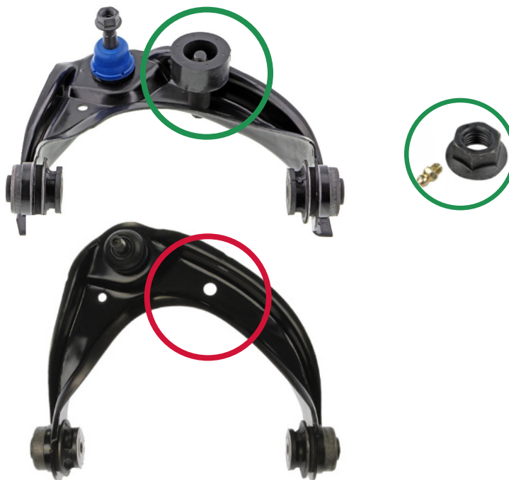
Figura 1. Brazo de control Supreme de Mevotech con junta esférica de metal sinterizado autolubrificante engrasable, tope preinstalado y hardware (arriba) vs brazo de control estilo equipo original (abajo)
