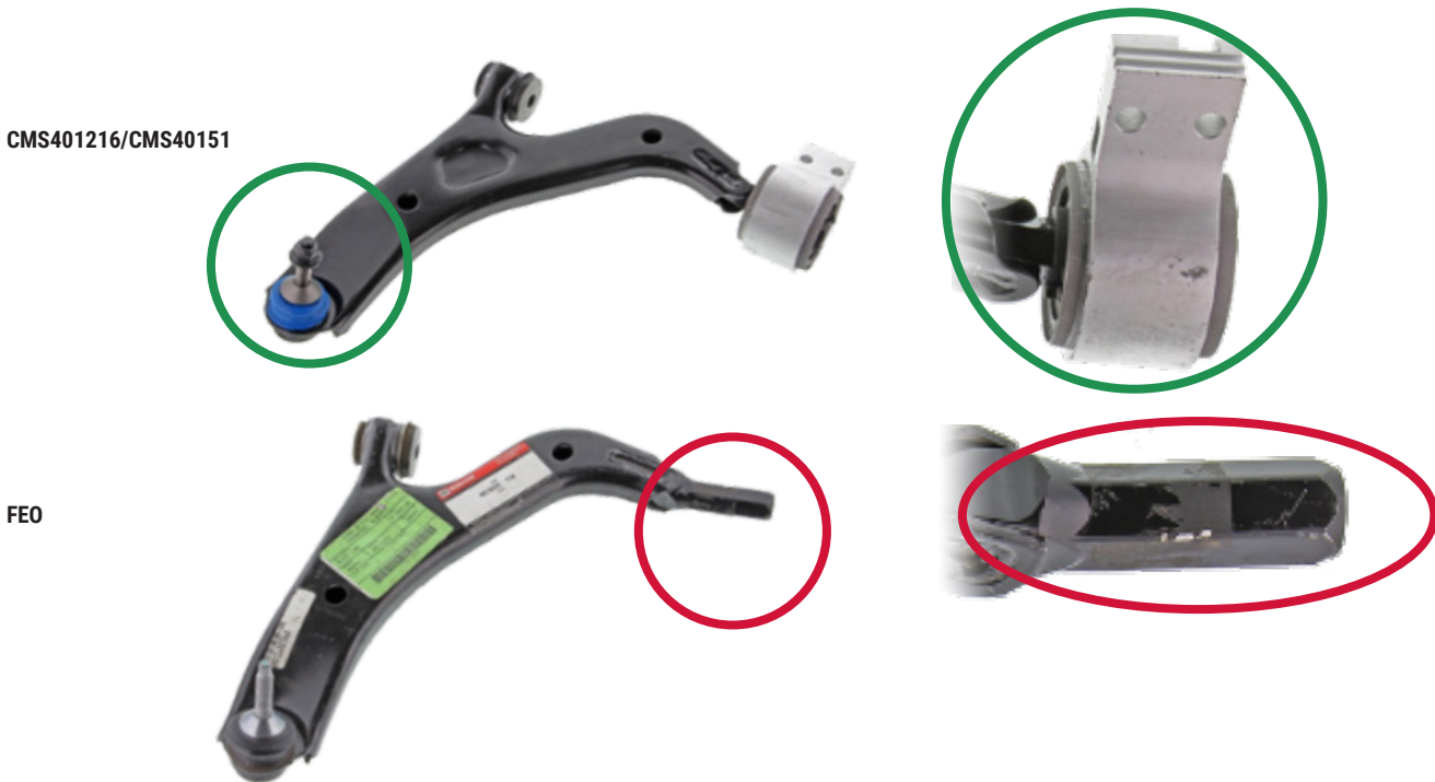
Figure 1. Bras de suspension Mevotech Supreme avec bague de conformité prémontée (en haut) comparativement au bras de suspension d'origine (en bas).
