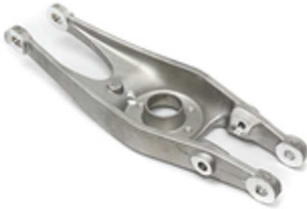
Figura 2. Brazo de control trasero inferior serie M con fabricación de aluminio
